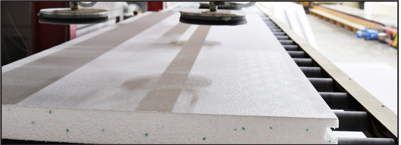
Sandwichelement - bestehend aus einem Polystyrolkern (EPS) mit beidseitigen Deckschichten.
